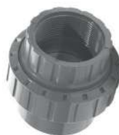
UNION 3 PIÈCES PVC-C GRIS Femelle à coller et taraudée pas du gaz cylindrique - Joint torique EPDM REF. BIFC
