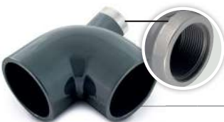
COUDE 90° PN 16. Avec piquage. Femelle à coller. Taraudée pas du gaz. REF. GIMPV
