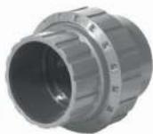
UNION 3 PIÈCES ABS - PN 10 Femelles à coller - Joint torique EPDM- REF. 11205
